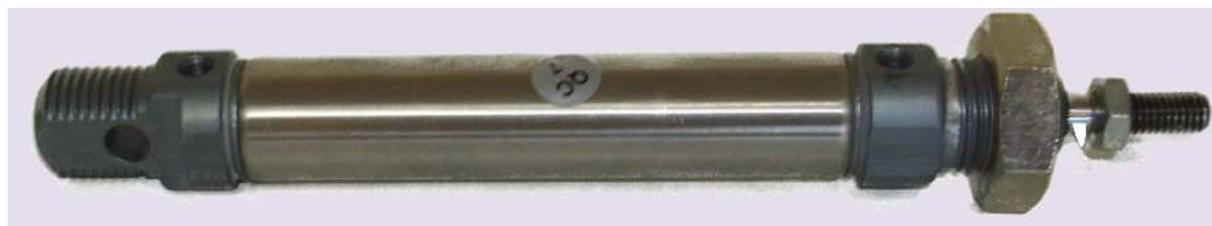
Cilindros neumáticos de simple y doble efecto, fabricados según norma ISO 6432, en diámetros 16-20 y 25 mm y en diferentes carreras. Fabricados en camisa de acero anodizado de alta resistencia y bajo rozamiento, vástago en acero cromado, culatas en aluminio anodizado.
